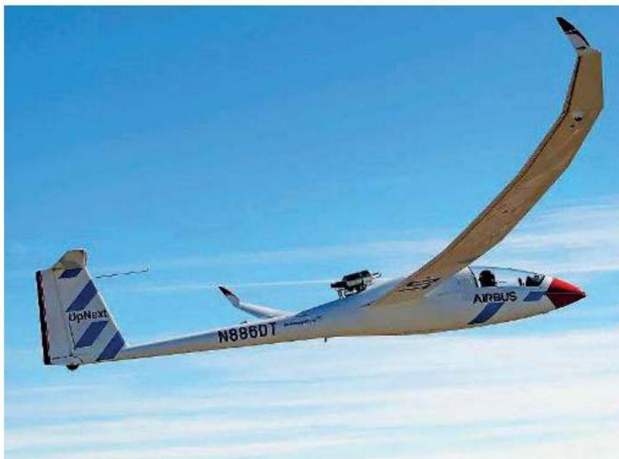
L'aliante modificato. Il Blue Condor di Airbus Upnext alimentato a idrogeno
